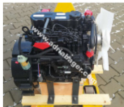
MOTOR 10.5KW, 1500/MIN, MITSUBISHI S3L2
