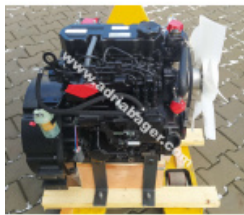
MOTOR 10.5KW, 1500/MIN, MITSUBISHI S3L2
