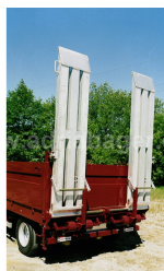
4.9 T/PAR, 4 M DOLŽINA, CR.150/40NB ALU. RAMPE
