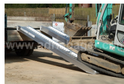
RA. 170X45; 5,6T/PAR, 4,5M DOLŽINA, ALU. RAMPE Z ROBOM
