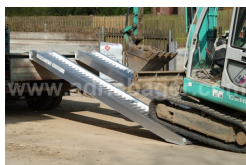
RA. 150X45; 4,1T/PAR, 4,5M DOLŽINA, ALU. RAMPE Z ROBOM
