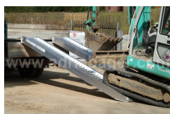
RA. 170X40; 7,5T/PAR, 4M DOLŽINA, ALU. RAMPE Z ROBOM
